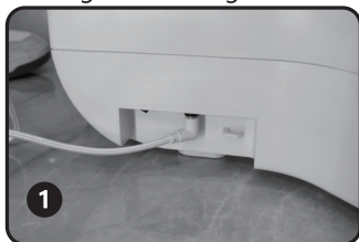
① Schakel de stroom uit voor onderhoud en reiniging, gebruikers kunnen de adapter/achterste stekker van de hoofdeenheid loskoppelen.
