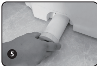
⑤ Retirer la boîte de charbon, il est recommandé de la sortir et de l'exposer au soleil une fois par mois, et de la remplacer tous les six mois.
