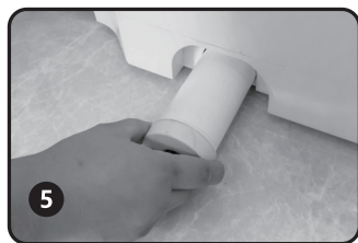
⑤ Estrarre la scatola del carbone, si consiglia di estrarla ed esporla al sole una volta al mese e sostituirla ogni sei mesi.
